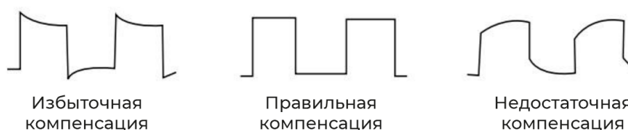
Рис. 4-2. Калибровка компенсации щупа
