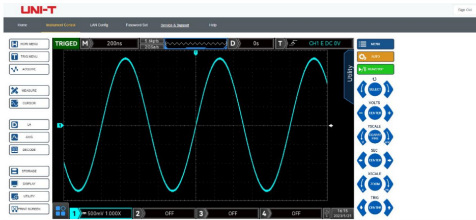
Рис. 13-8. Удалённое управление осциллографом через веб-интерфейс, отображение сигнала на экране
